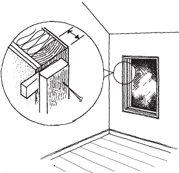
Montera väggluckan i hålet genom att kila fast den med träkilar.
